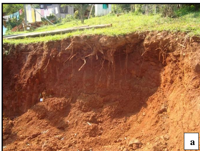
Figura 33. Ponto 15. Obras e escavações em colúvio na área urbana (a) Perfil típico de colúvio oriundo da remobilização de solos desenvolvidos a partir dos basaltos. (b) Observe-se o caráter essencialmente argiloso e bimodal com blocos de rocha (corestone).
