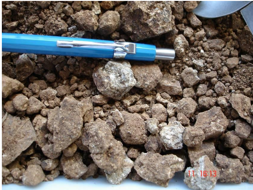
Figura 2. Solo saprólítico de basalto – aspecto do solo seco em laboratório.
