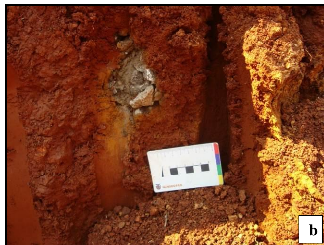
Figura 33. Ponto 15. Obras e escavações em colúvio na área urbana (a) Perfil típico de colúvio oriundo da remobilização de solos desenvolvidos a partir dos basaltos. (b) Observe-se o caráter essencialmente argiloso e bimodal com blocos de rocha (corestone).
