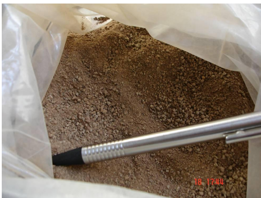
Figura 8 - Aspecto do solo após destorroamento manual – destruição completa dos grãos de maior diâmetro, material 99% passante na peneira #4 (2,0mm).
