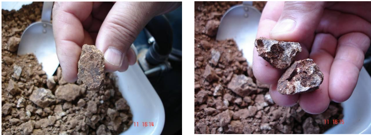
Figura 6 – Fragilidade dos grãos grosseiros do solo saprolítico de basalto.
